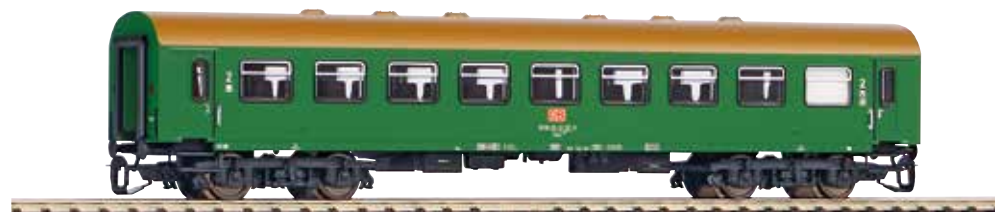
Mitte der 1960er-Jahre entstanden im Reichsbahnausbesserungswerk Halberstadt die vierachsigen Rekowagen mit Mittelgangaufteilung. > siehe Seite 29
