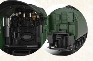
Führerstand mit detailliert ausgeführter Kesselrückwand und Tendervorderseite. Die Führerstandsbeleuchtung und das Flackern in der Feuerbüchse sind digital schaltbar. Fein detaillierte Kesselringe separat angesetzt.
